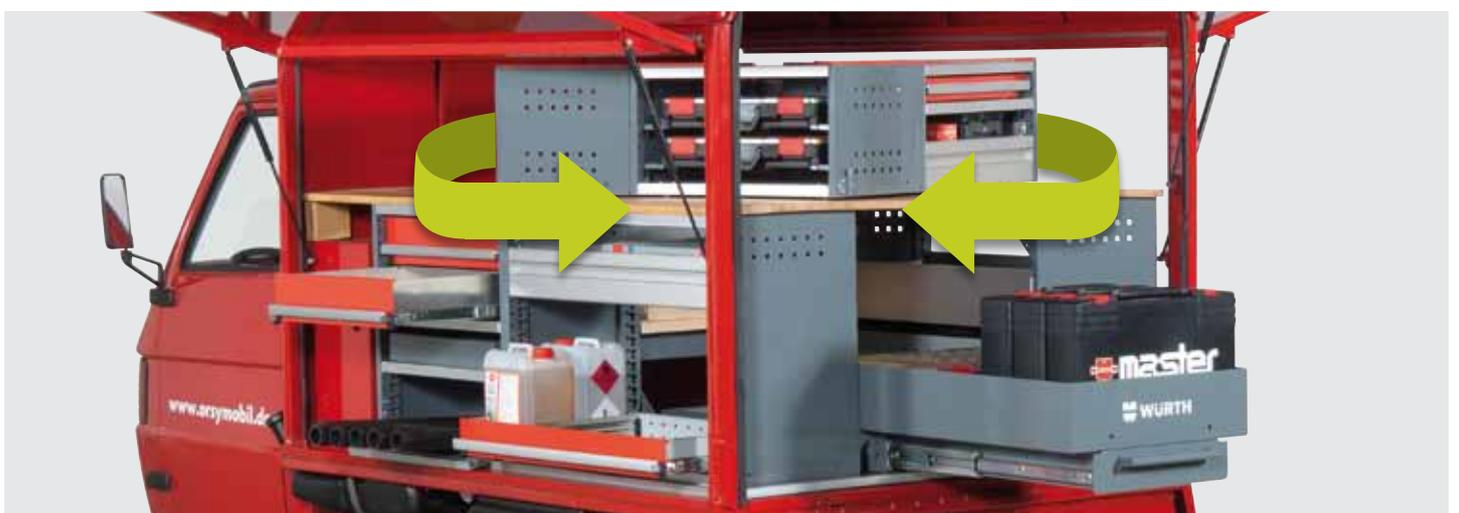
Das um 360° drehbare Einrichtungskarussell erlaubt den vollständigen Zugriff auf Werkzeuge und Maschinen von nur einer Fahrzeugseite aus.
