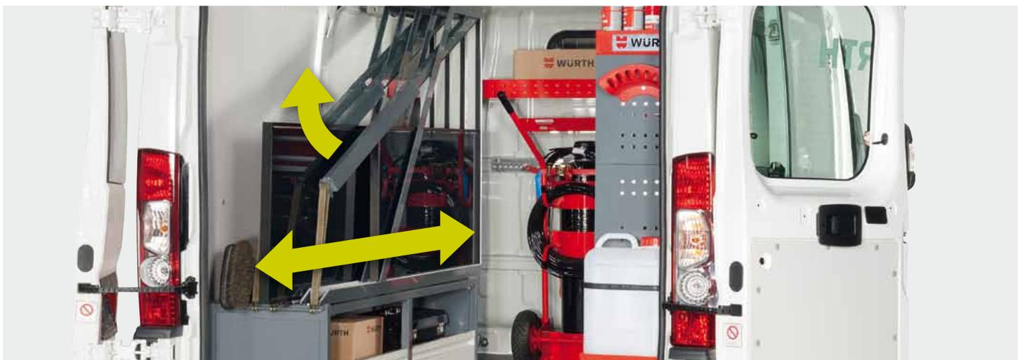
Die Solarmodule lassen sich dank der aufschwenkbaren Fixierschiene sicher und schnell be- und entladen.
