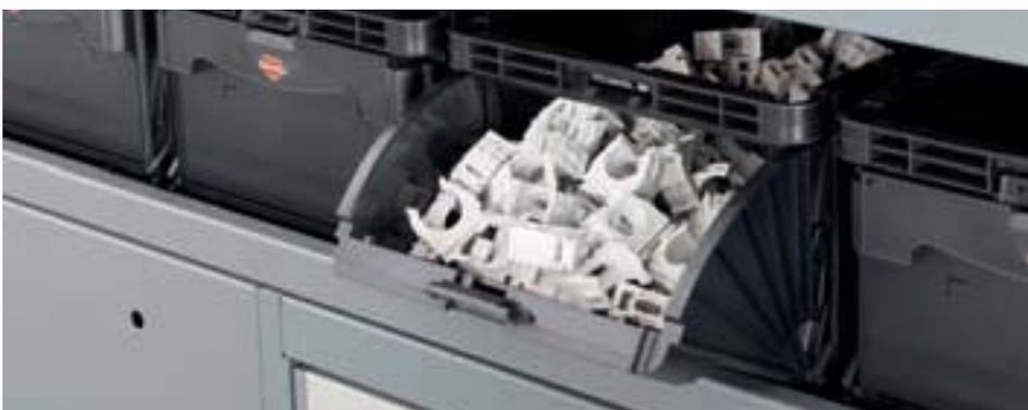
Lagerboxenregale machen die Lagerung von Kleinteilen im Transporter übersichtlich. Die im Regal fixierten Boxen bringen Ordnung und die patentierte Frontklappe ermöglicht den leichten Zugriff.
