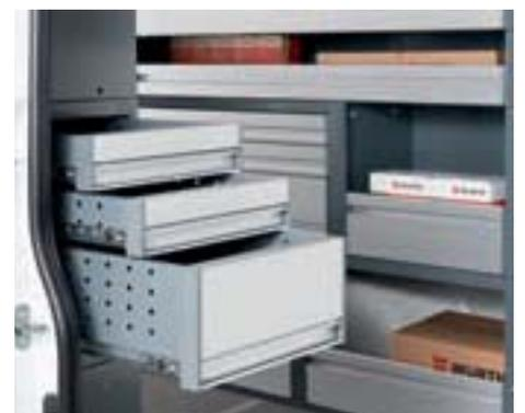
Längsmodule bieten einen komfortablen Zugriff von der Seitentüre aus.
